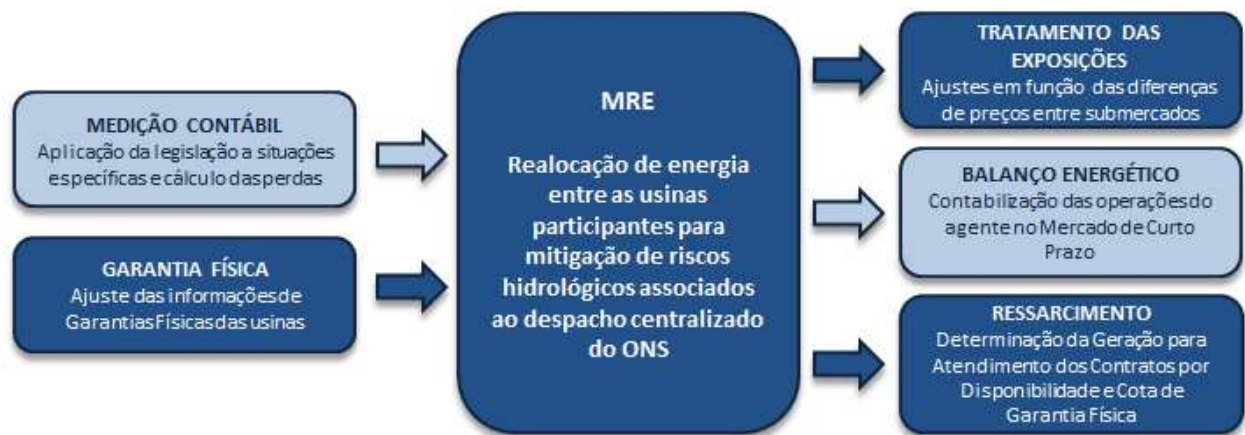
Figura 1: Relação do módulo Mecanismo de Realocação de Energia: Relação com o Cálculo de Exposição e Apuração de Diferenças
