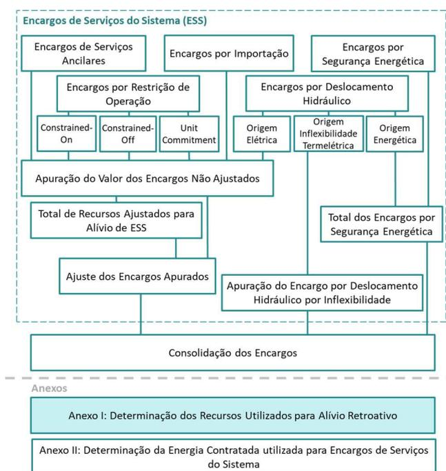
Figura 22: Esquema Geral do Módulo de Regras: “Encargos”
